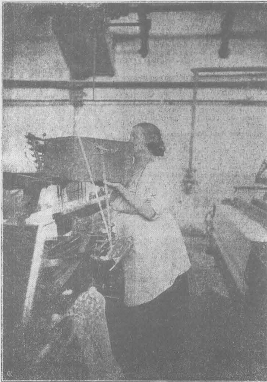
Ricaricamento del serbatoio delle spole di un telaio automatico.
